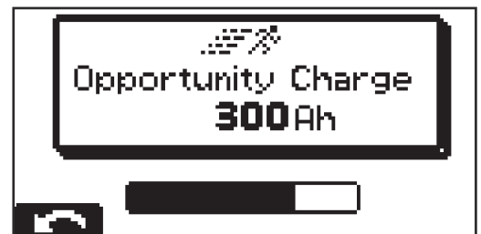
Anzeige bei Start der Zwischenladung
